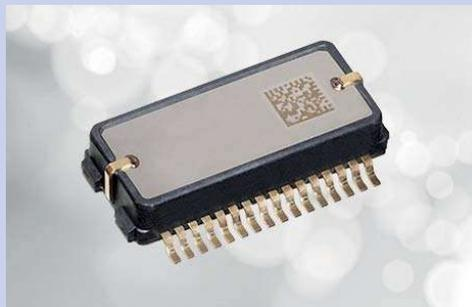
Für Einsätze zur hochpräzisen Maschinensteuerung und zur Unterstützung der GNSS-Positionsbestimmung (Global Navigation Satellite System) konzipiert ist der MEMS-basierte XYZ-Achsen-Inertialsensor SCHA63T von **Murata**. Er verfügt über sechs Freiheitsgrade und ist mit einer digitalen SPI-Schnittstelle ausgestattet. Zu den Besonderheiten des Sensors gehört seine im Bereich von nur 1°/h liegende
