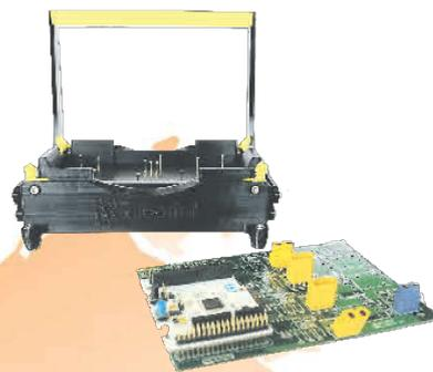
**Maßarbeit:** Für jede Platine entwickelt Eloprint mit einer CAD-Software einen Prüfadapter inklusive Prüfnadeln. Foto: Eloprint
