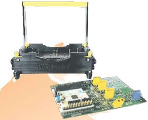
**Maßarbeit:** Für jede Platine entwickelt Eloprint mit einer CAD-Software einen Prüfadapter inklusive Prüfnadeln. Foto: Eloprint
