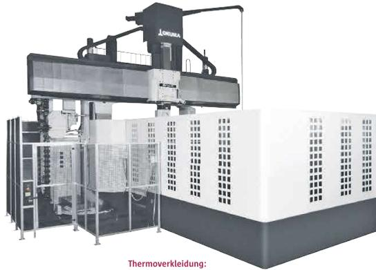
**Thermoverkleidung:** Große Doppelständerfräsmaschinen von Okuma sind komplett eingehüllt. So werden punktuelle Wärmeübertragungen von außen verhindert. Foto: Okuma
